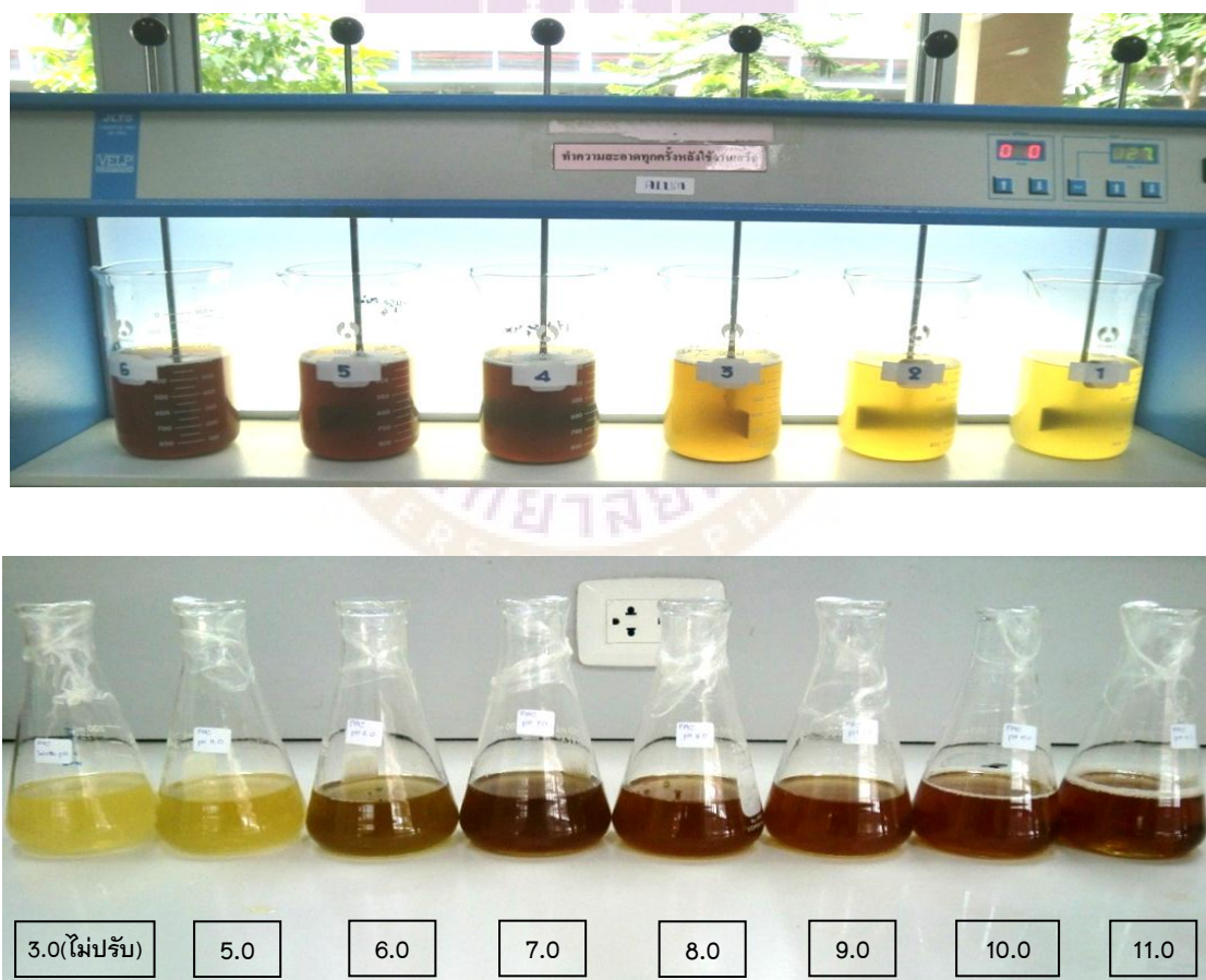
ภาพ 20 น้ำเสียกรดน้ำส้มเมื่อปรับค่าพีเอชต่าง ๆ ด้วย NaOH หลังทำ Jar test
