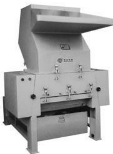
ภาพ 3 เครื่องโม่ กำลังแรง 30 แรงม้า
