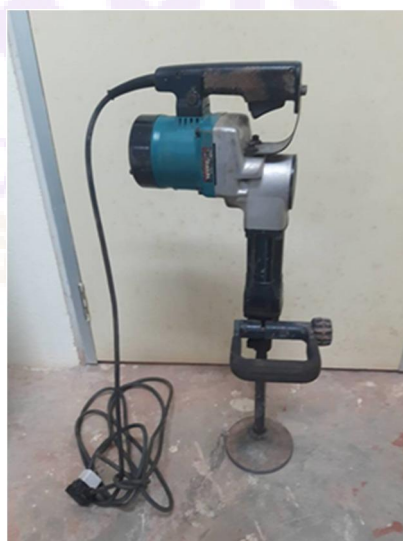
ภาพ 19 เครื่องมือกระแทกที่ใช้ในทดสอบการบดอัดแบบสูงกว่ามาตรฐาน
