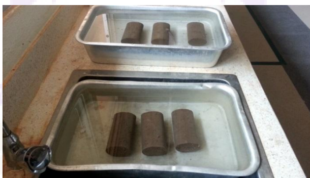
ภาพ 23 การแช่น้ำ 4 ชั่วโมงสำหรับตัวอย่างทดสอบกำลังรับแรงอัดแกนเดียว
