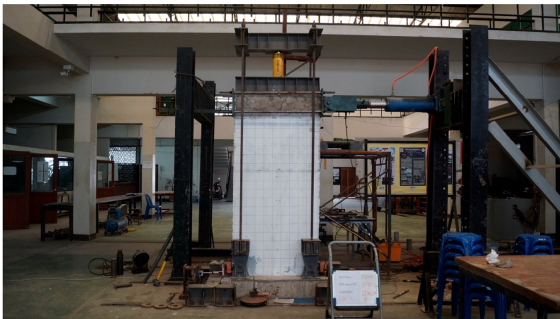
ภาพ 63 แสดงภาพถ่ายการติดตั้งชิ้นทดสอบในห้องปฏิบัติการ
