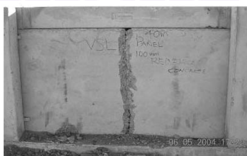
ภาพ 36 แสดง NSC Panel 4 – After Explosion
