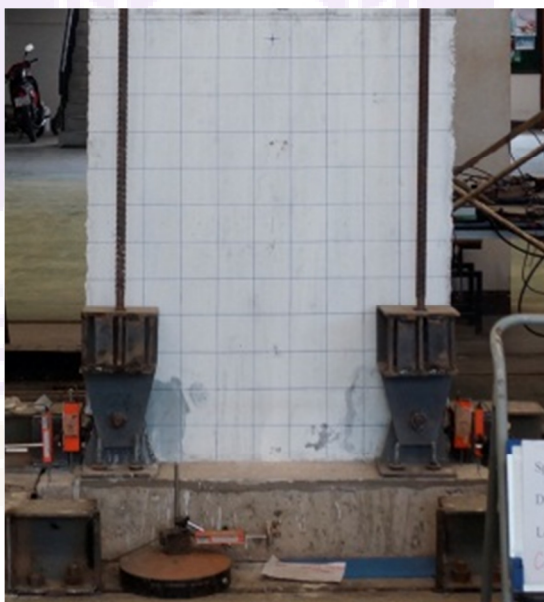
ภาพ 79 แสดงการเริ่มต้นเริ่มให้แรงกระทำด้านข้าง ที่ Drift ratio เท่ากับ 0.10% Cycle ที่ 1
