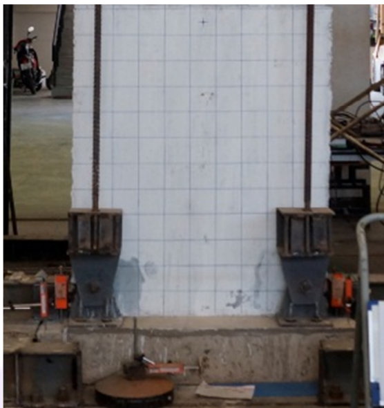
ภาพ 80 แสดงการเริ่มต้นเริ่มให้แรงกระทำด้านข้าง ที่ Drift ratio เท่ากับ 0.15% Cycle ที่ 4
