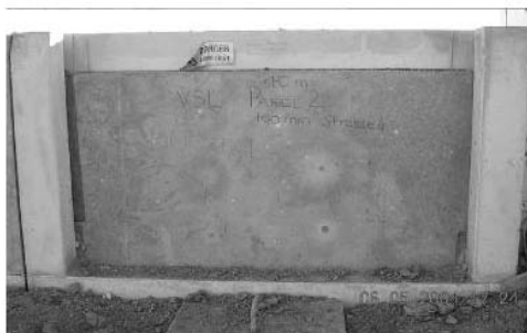
ภาพ 35 แสดง Panel 3 After Explosion
