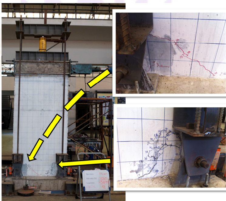
ภาพ 85 แสดงรูปแบบการวิบัติของชิ้นทดสอบผนังคอนกรีตเสริมเหล็กหล่อสำเร็จ
