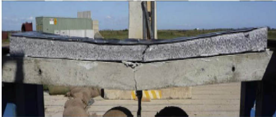
ภาพ 40 แสดง Slab and aluminium foam deformation Event 4, 2009
