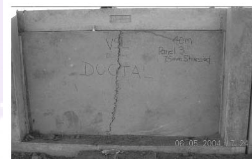
ภาพ 34 แสดง UHSC Panel 2 After Explosion
