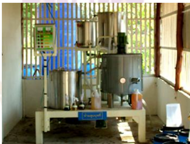
ภาพ 7 แสดงเครื่องผลิตน้ำมันไบโอดีเซลชุมชน
