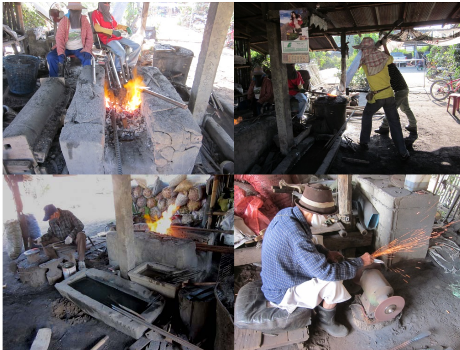
ภาพ 4 กระบวนการตีมีดที่บ้านร้องตีมีด
