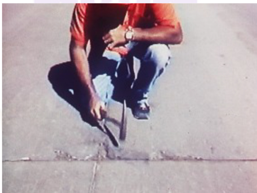
ภาพ 28 แสดงการตรวจสอบความเสียหายของคอนกรีต
