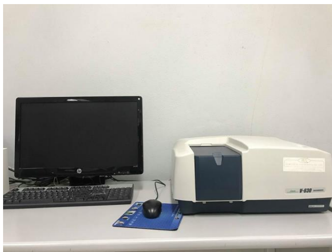
ภาพที่ 11 เครื่องยูวี-วิสิเบิลสเปกโทรโฟโตมิเตอร์ (UV-VIS Spectrophotometer, Jasco รุ่น V-530)
