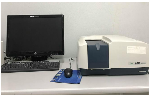
นำไปวิเคราะห์ด้วยเทคนิคยูวี-วิสิเบิล สเปกโทรสโกปี
