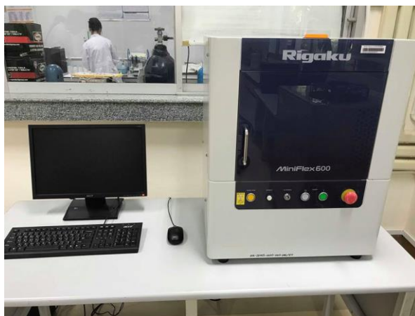
ภาพที่ 8 เครื่องเอกซเรย์ดิฟแฟรคโตมิเตอร์ (X-ray diffractometer : XRD, Rigaku รุ่น MiniFlex600)
