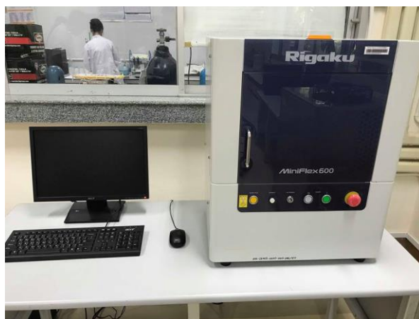
ภาพที่ 14 เครื่องเอกซเรย์ดิฟแฟรกโตมิเตอร์ (X-ray diffractometer : XRD, Rigaku รุ่น MiniFlex600)
