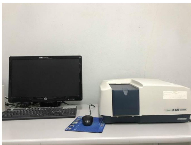
ภาพที่ 13 เครื่องยูวี-วิสิเบิลสเปกโทรโฟโตมิเตอร์ (UV-VIS Spectrophotometer, Jasco รุ่น V-530)
