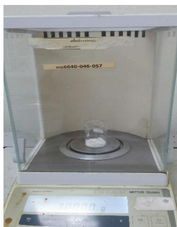
ทำการชั่ง \text{TiO}_2 3.0000 กรัม ลงในปิกเกอร์ขนาด 10 มิลลิลิตร
