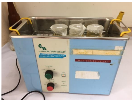
นำสารไปไซนิเคท ด้วยเครื่องอัลตราโซนิก เป็นเวลา 30 นาที
