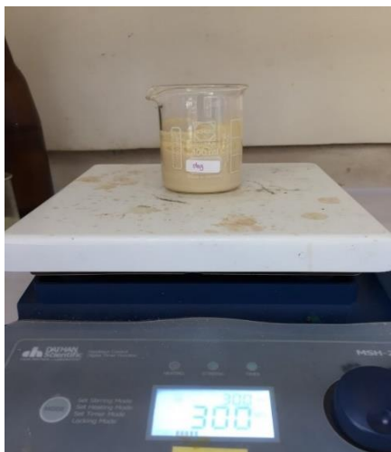
นำไป stirrer เป็นเวลา 30 นาที ณ อุณหภูมิห้อง
