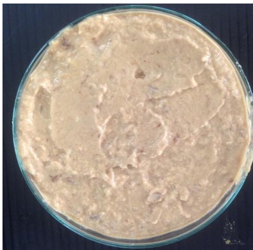
ภาพ 38 แสดงมันสำปะหลังที่ผ่านกระบวนการหมักร่วมกับหัวเชื้อจุลินทรีย์หมักไว้เป็นระยะเวลา 15 วัน
